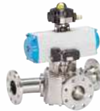
Zweiwege-Molchweiche 1 Eingang, 2 Ausgänge, 120°/180° Bewegung, manuell, automatisiert
