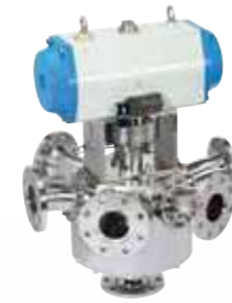
Mehrwege-Molchweiche 1 Eingang vertikal, 6 Ausgänge horizontal, manuell, automatisiert
